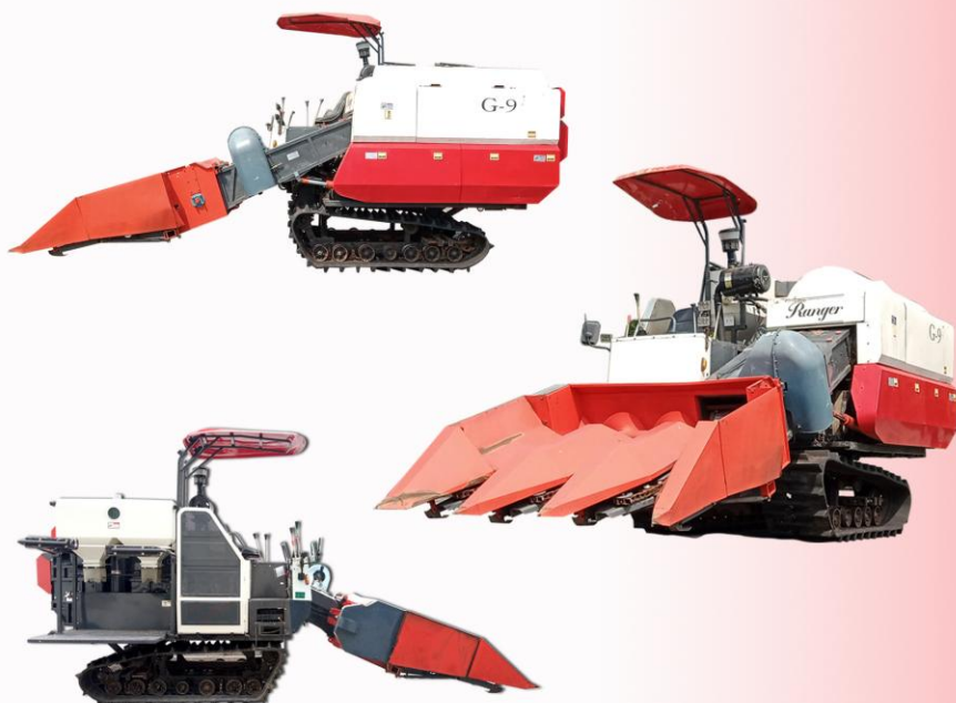
Ground clearance 45 cm (jarak ketinggian dari permukaan tanah), Lebar roda 55 cm
